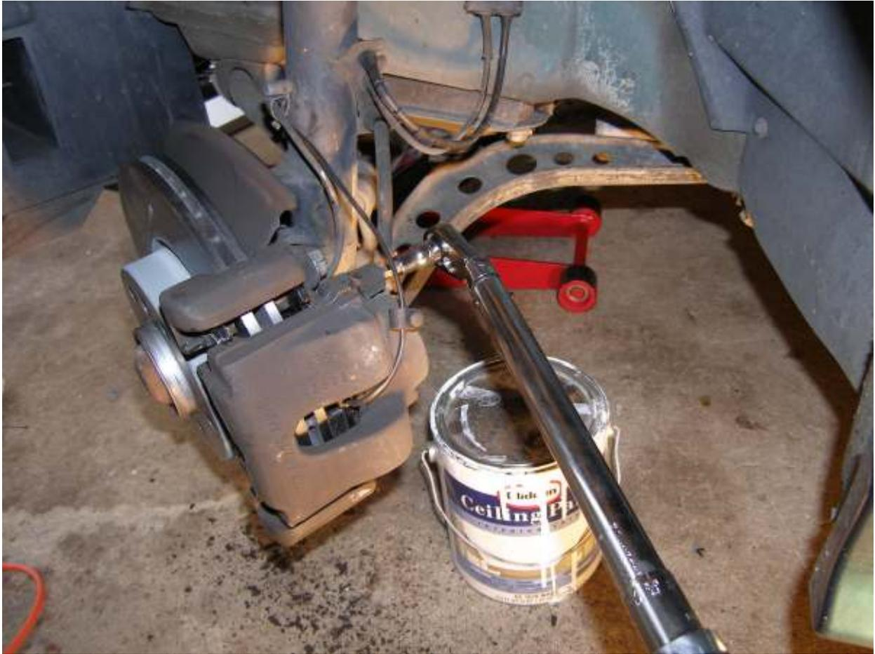
把卡钳分离以后，需要使用别的物体支撑刹车卡钳，**切勿让卡钳的重量完全由刹车软管支撑，否则有可能造成非常严重的后果。**图中使用了铁罐，也可以使用别的物体。
