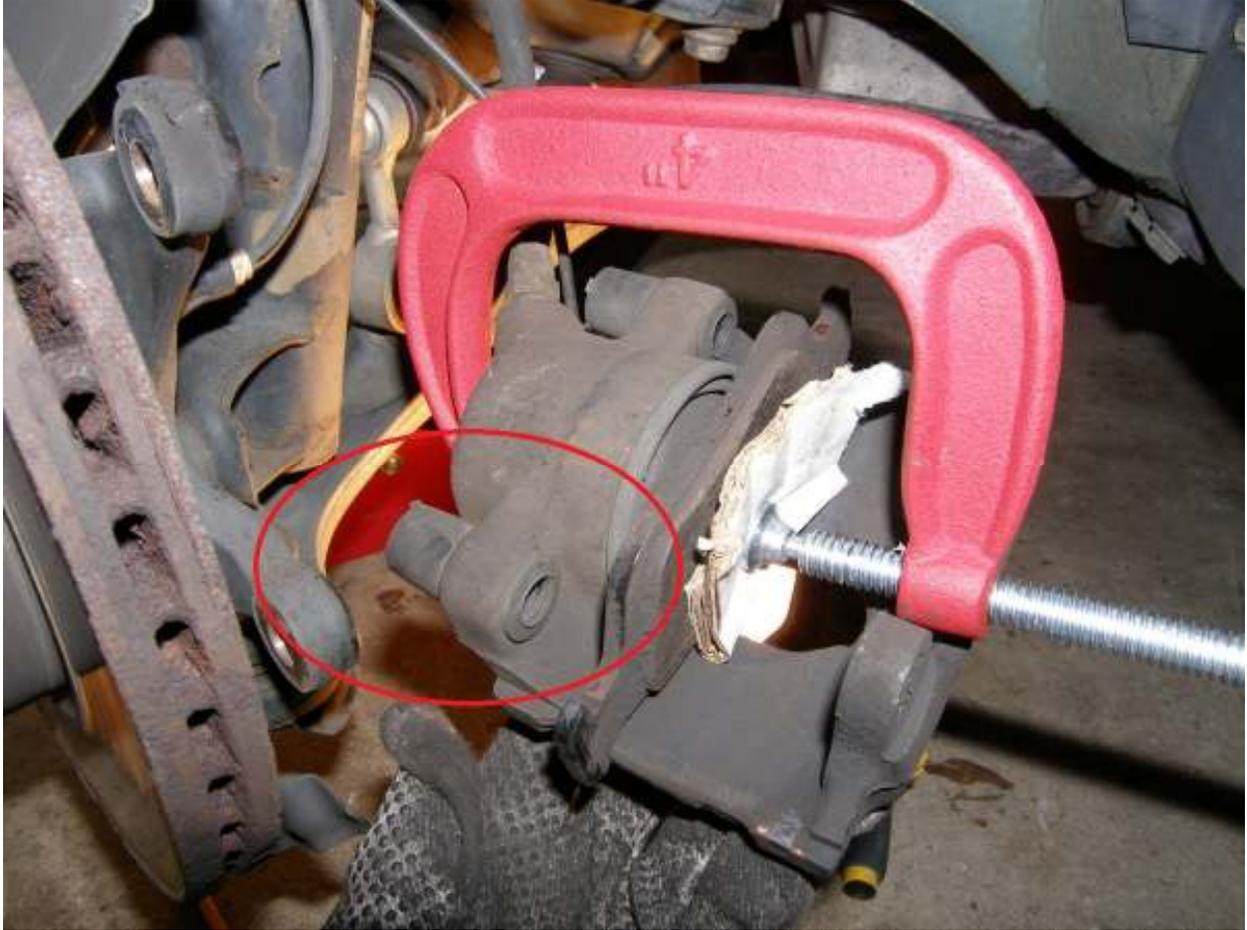
接下来，就要将黄铜导轨安装进去。卡钳在原厂橡皮导轨的环形洞内有可能已经有一些锈蚀，黄铜导轨可能会遇到一些阻力。可能的话，用 150-400 号砂纸打磨一下内部。把黄铜导轨安装好，**方向参照下面 2 张图片，一定不能搞错方向。**把限制环安装好。
