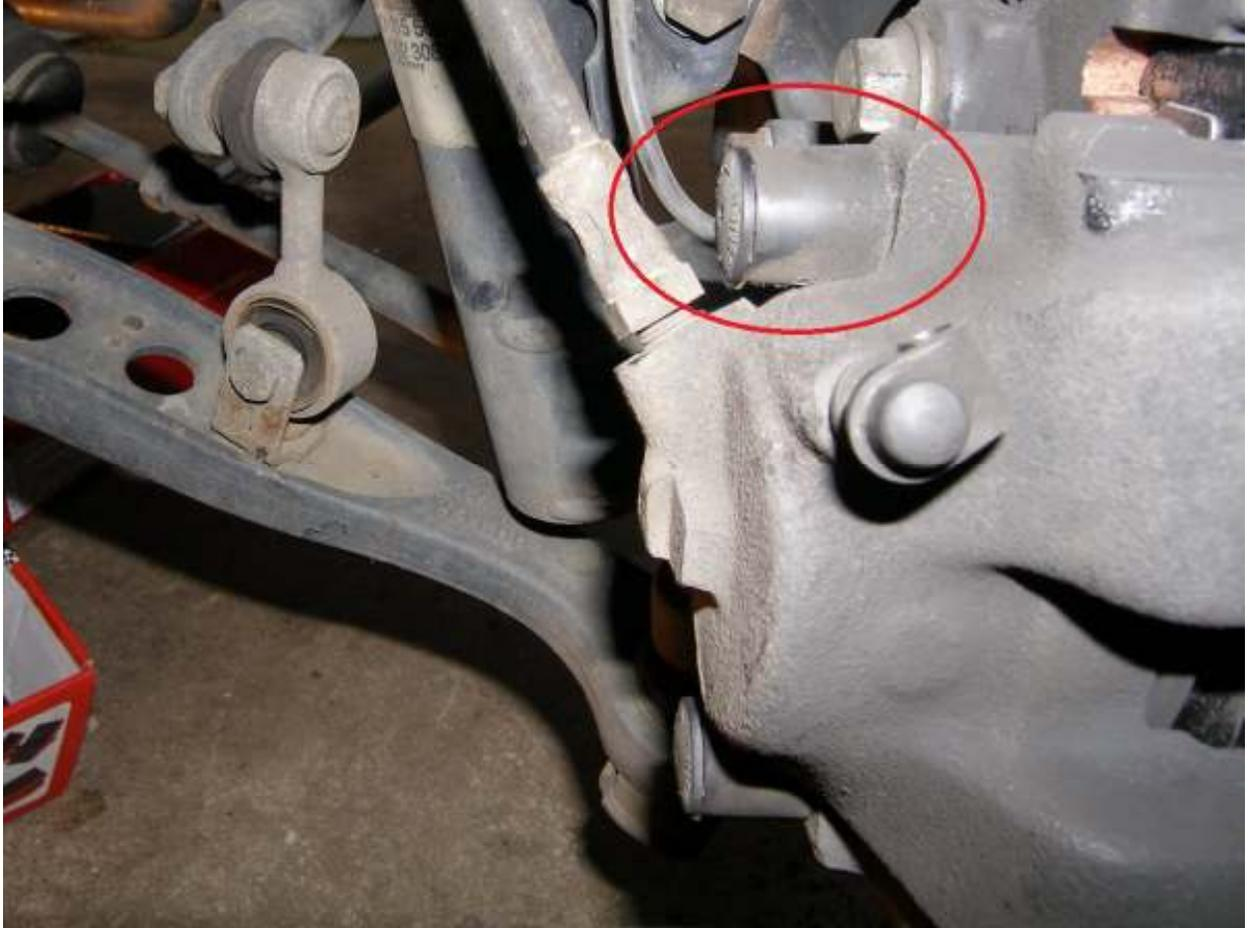
使用一字螺丝刀把顶部的防尘盖撬掉。暴露出来 7mm 内六角螺丝。这 2 颗螺丝是不锈钢的，需要重新使用，所以要特别当心不要损坏。
